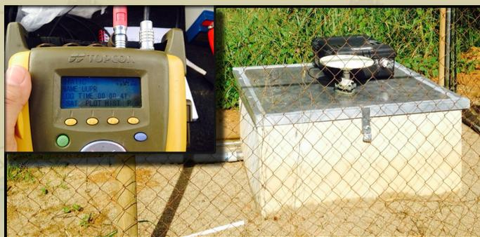
Figura 15. Estación sísmica UUPR en Utuado. Prueba de GPS para determinar la localización exacta de la estación sísmica. (RSPR- UPRM).
